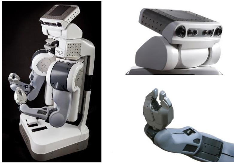
Figura 12. Robot PR2 (vista completa, cabeza y pinza). Fuente: web de Willow Garage.
