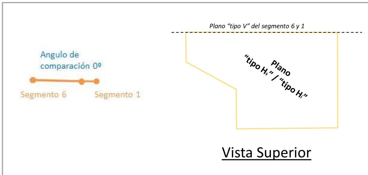
Figura 3.42. Caso de ángulo de comparación menor (izquierda). No se calcula punto de reconstrucción al pertenecer los segmentos al mismo plano "tipo V" (derecha).
