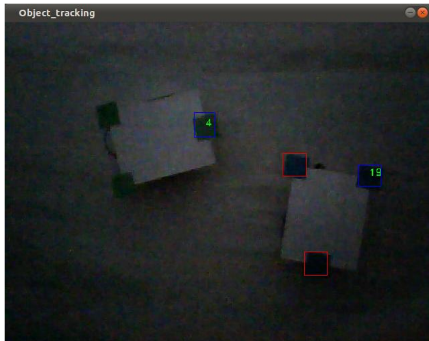
Figura 5.14: Entorno de trabajo con baja iluminación y resultados del etiquetado sobreimpresionados.
