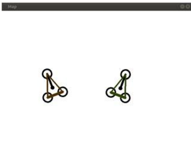
Figura 5.3: Mapa virtual representando dirección y sentido de los robots con las etiquetas iniciales
